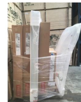
Palettisation non conforme (dôme mal placé)
