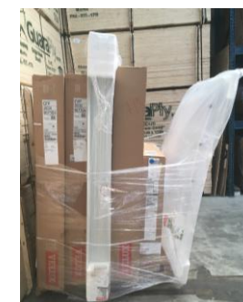
Niet-conforme palettisering (afdekschelp slecht geplaatst)
