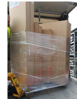
Niet-conforme palettisering (slecht strapping - bewegen tijdens transport)
