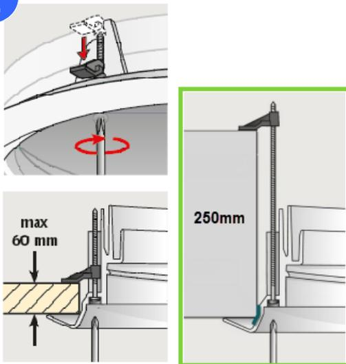
Die Befestigungsverschraubung des Deckenrings ist bis zu einer max. Materialdicke von 60mm ausgelegt.
