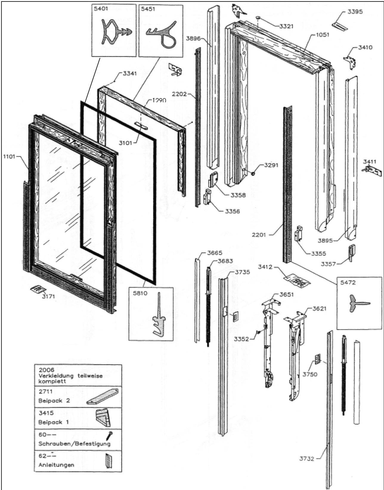
Obenelement GEL: Verglasung, Verglasungsdichtung, Beschläge, Abdeckbleche, Kleinteile
