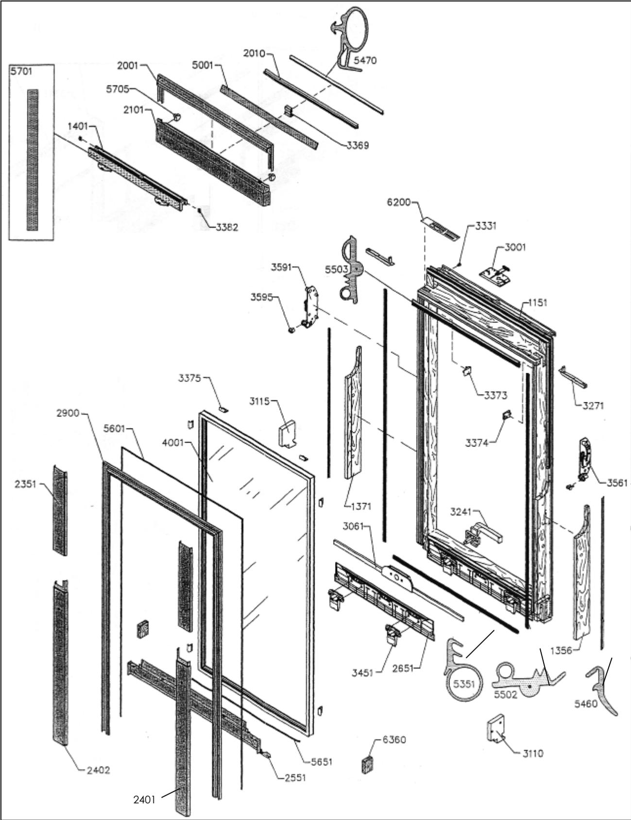
Untenelemente VEA/B/C: Flügel, Blendrahmen, Dichtungen, Beschläge, Abdeckbleche, Kleinteile
