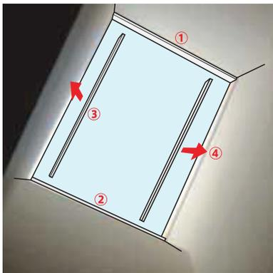
天窓の取り付け下地調整後に、横方向の見切り材を先に取り付けると綺麗に仕上がります。
