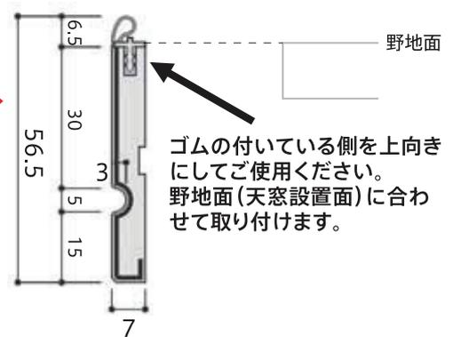
見切り材のゴムの付いている側を上向きにして40mm程度の隠し釘(現場調達)などで取り付けます。
