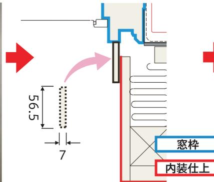
天窓を設置する前に野地面(天窓設置面)に合わせて見切り材を取り付けます。
