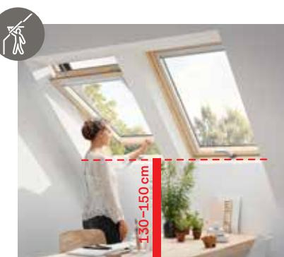
Langų modeliai: GZL B, GLU B, Standard GLL B, GLU B, Standard Plus GLL B, GLU B
