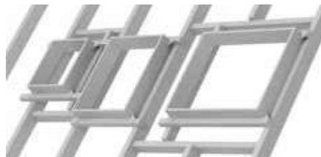
VELUX krovni prozori se proizvode u različitim standardnim dimenzijama i ugrađuju se u određena rastojanja između greda. Kada rastojanje između greda nije dovoljno, vrši se blago prilagođavanje postojećeg okvira, bez smanjenja snage i bezbednosti krova.
