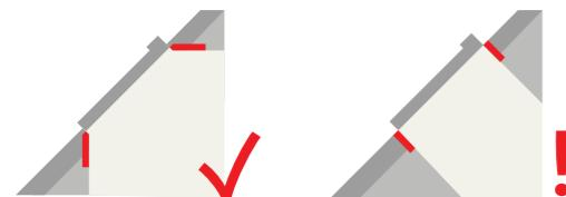
İkinci kural; çatı penceresinin altına bir radyatör yerleştirmektir. Bu, sıcak havanın pencereye akmasına ve pencere boğnesi boyunca dolaşmasına izin verir ve yoğuşma riskini ortadan kaldırır.
