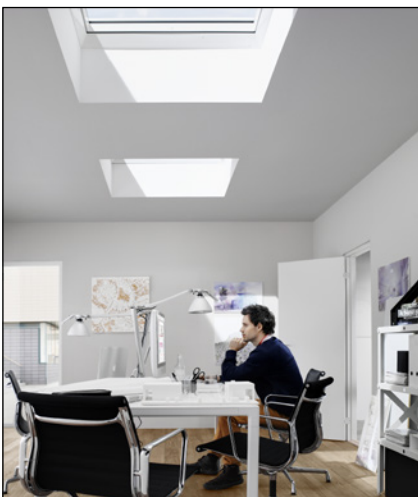
VELUX Flachdach-Fenster sind gemäss GS-BAU-18 durchsturz sicher
