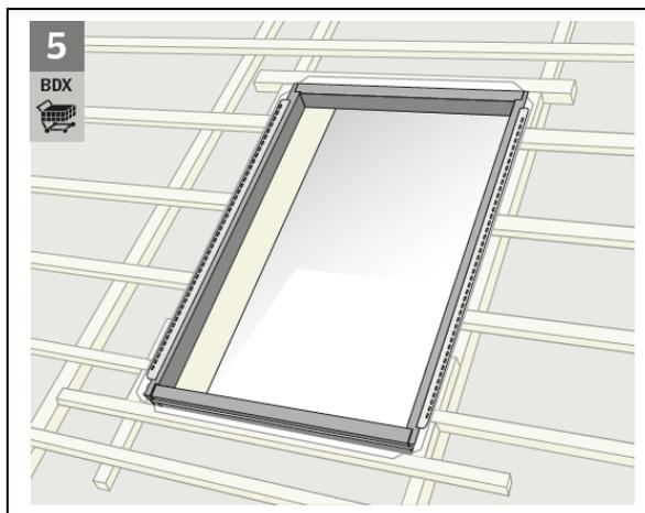
Anschließend wird der Fensterrahmen in den Dämmrahmen eingelegt und beides mit der Unterkonstruktion verschraubt.
