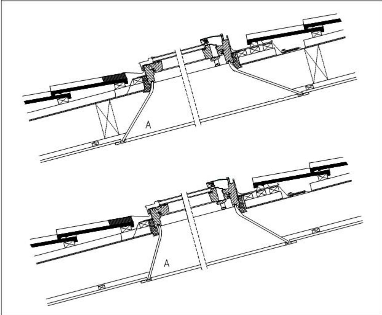
Verlauf der Innenfutter-Breitenteile (Ober- und Unterteile) bei einer Dachneigung von 60° bis 90°.
