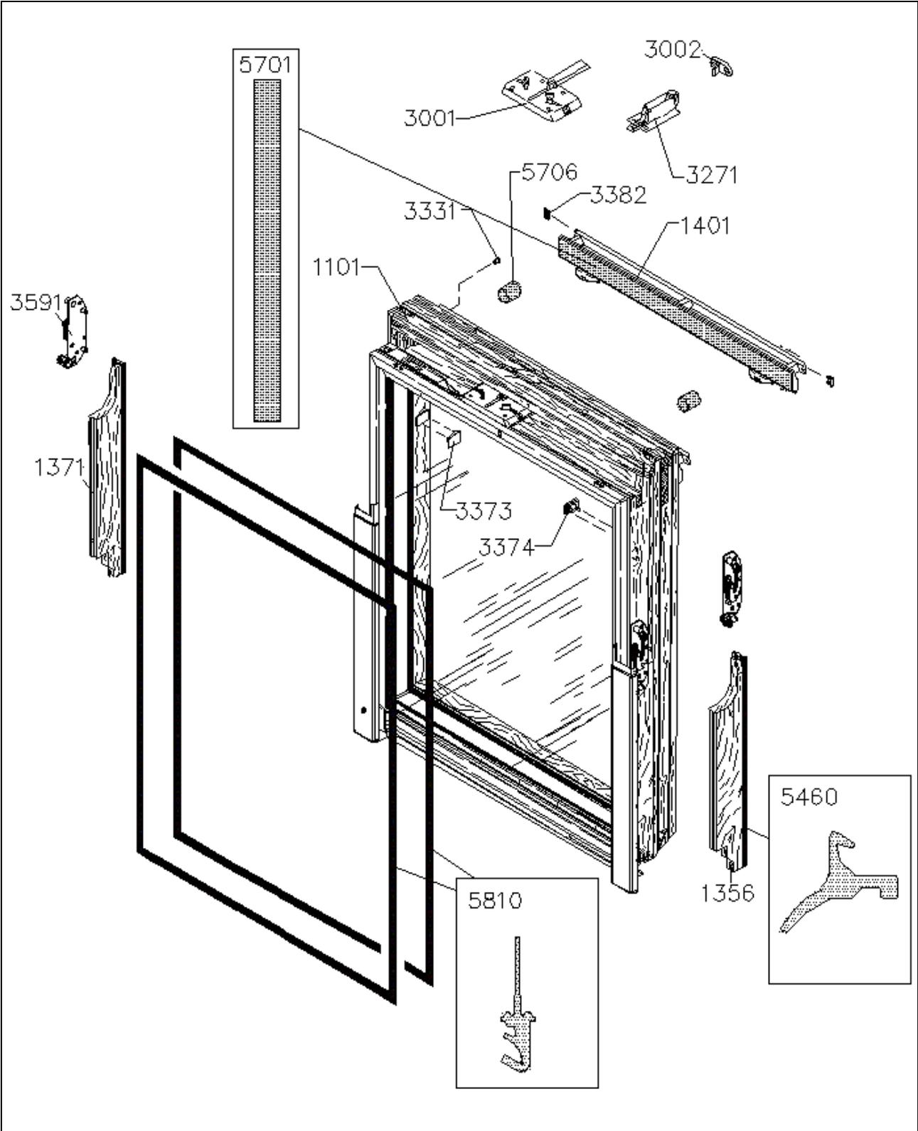
Isolierverglasung, Verglasungsdichtungen, Glasleisten, Abdeckbleche
