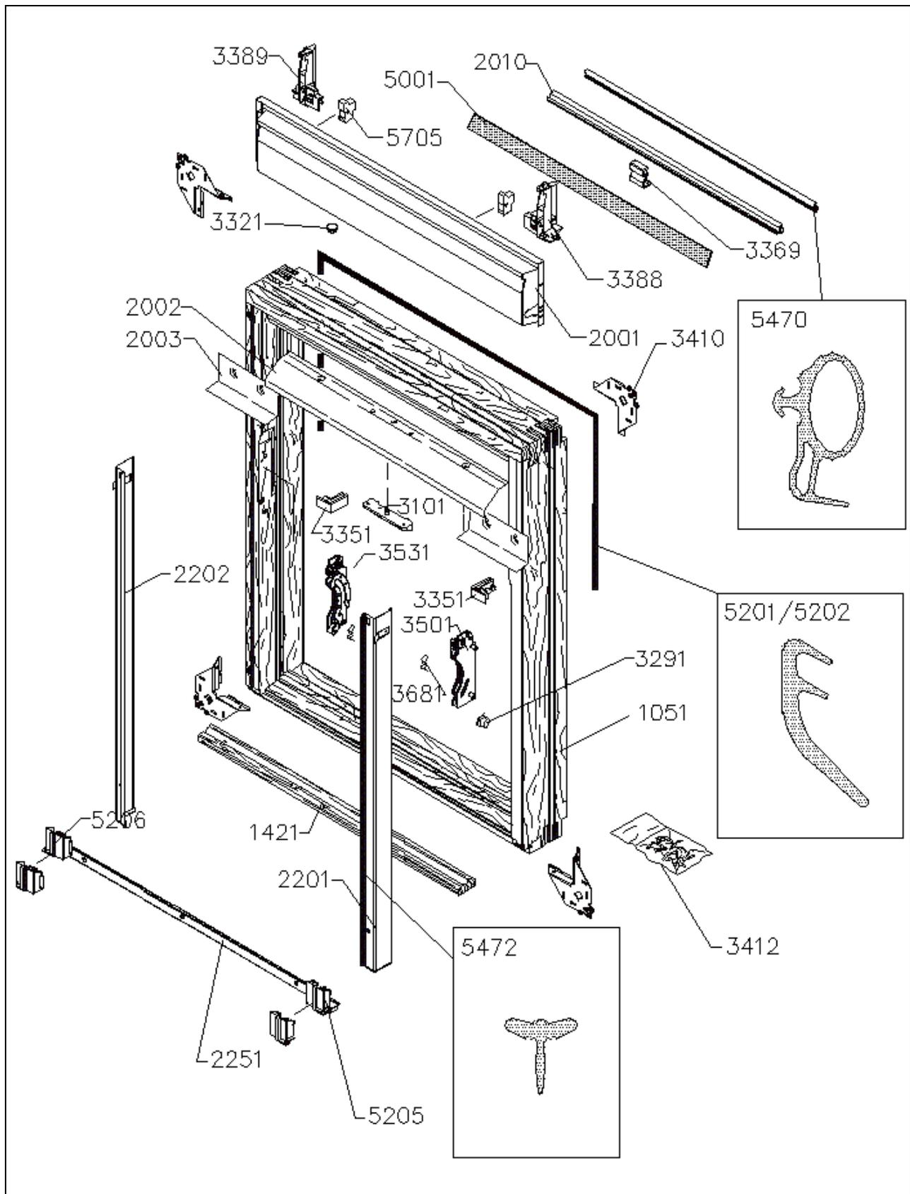
Flügel mit Scheibe, Flügeldichtungen, Beschläge, Lüftungsklappe mit Griffleiste
