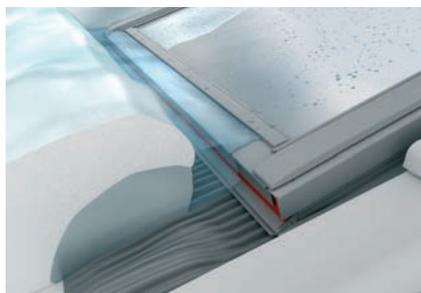
Kui aken on pikemat aega kaetud lume ja jääga ning kui jätta lumi ja jää eemaldamata, ei saa sulavesi ära voolata, sest akna alla on moodustunud jäävall ja vesi võib tungida läbi konstruktsiooni tuppa. Nüüd pakub VELUX võimalust paigaldada aknale lume ja jää komplekti, mis tõkestab jää kogunemist akna ümber ja vähendab vee sisseimbumise ohtu.
