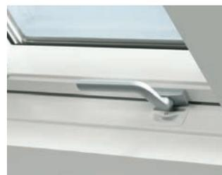
Mugavat käepidet saab fikseerida kahes asendis; esimeses asendis on aken suletud, teine asend on tuulutuseks.
