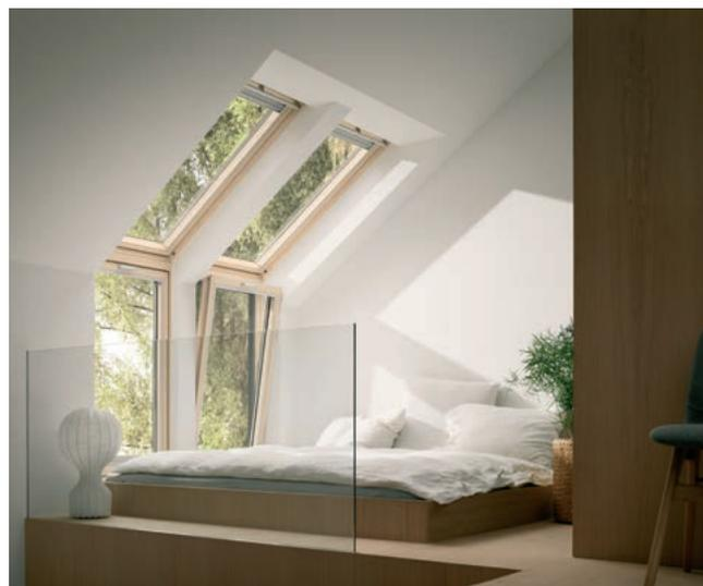
Vertikaalne aknaelement sobib ideaalselt sellisel juhul, kui viilualune sein on kõrgem ja ka sealt soovid välja vaadata. Seda saab paigaldada vaid koos katuseaknaga. VFE vertikaalne element on lakitud puidust, see on avatav (avaneb sissepoole). VIU vertikaalne element on kaetud valge poliüuretaankattega, see aknaelement ei ole avatav.
