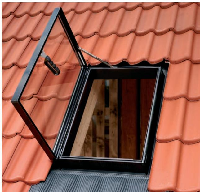
VLT katuseluuk on mõeldud spetsiaalselt soojustamata pööningutele, mida ei kasutata eluruumidena. Männipuidust valmistatud raami välispind on metallist viimistlusega ja leng on valmistatud alumiiniumist. Katuseluuk on varustatud klaaspaketi ja integreeritud veeplekkidega.
